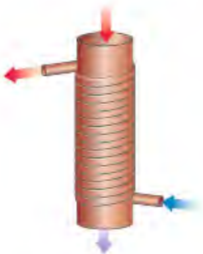
Ovan: Avloppsvärmeväxlare med avloppsröret omlindat med kallvattenröret. Till höger: Avloppsvärmeväxlare med avloppsröret omslutet av inkommande vatten.
