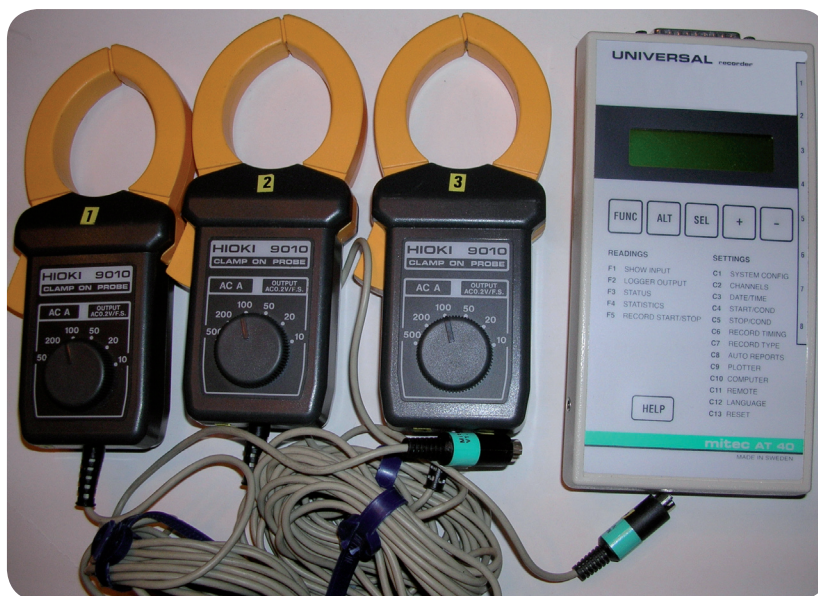
En Mitec datalogger användes för mätning av effekt och lastfördelning.
